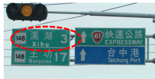
13 縣148線-確認點標誌
