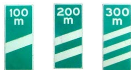
9 國道主線-預告點標誌
