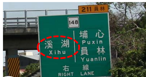
8 國道主線-預告點標誌
